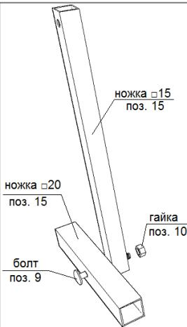
5.2.1. Соберите Т-образные ножки для крепления теплицы в грунт как показано на рис. 4.
