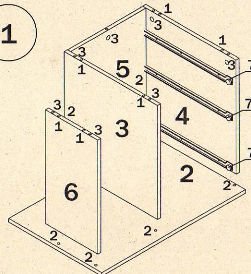
Далее к боковине 4 последовательно присоединить стенку заднюю 5 и стойку3. Крепление производить при помощи евровинтов (2). Далее установить каркас тумбы на дно 2. Фиксацию полки 2 произвести при помощи евровинтов (2). Присоединить деталь 6 к дну 2 евровинтами (2).
