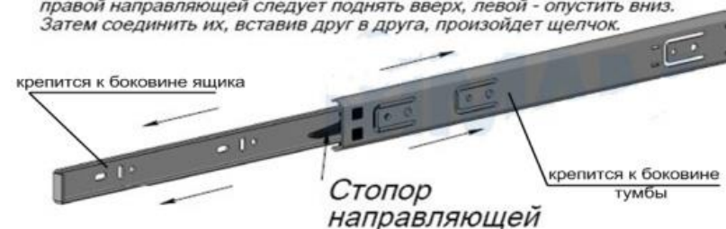
Рис.3 Схема установки шариковых направляющих
