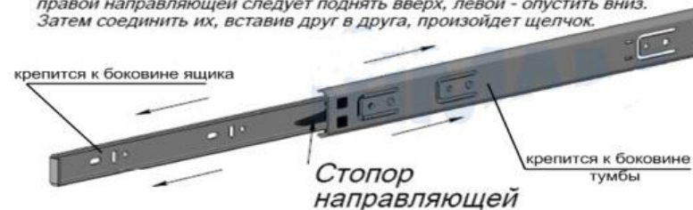
Рис.2 Схема установки шариковых направляющих
