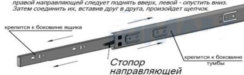
Рис.4 Схема установки шариковых направляющих
