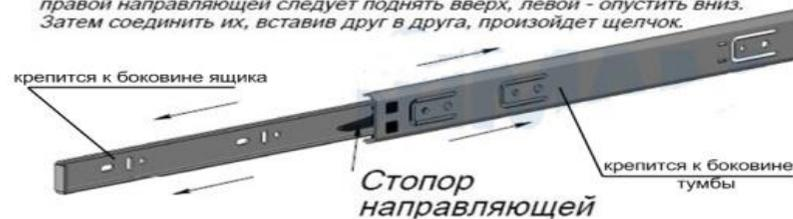
Рис.2 Схема установки шариковых направляющих
