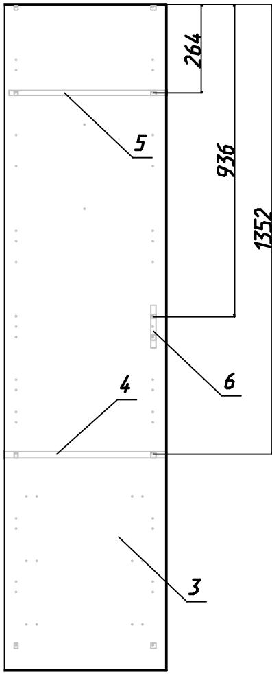
Рис.5 Схема установки деталей 4, 5, 6
