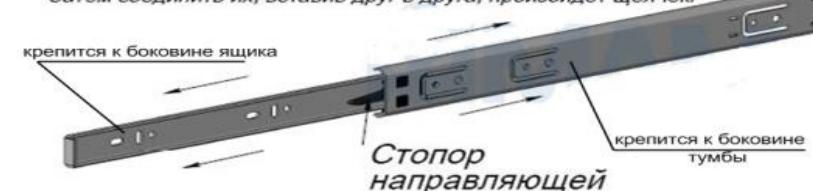
Рис.2 Схема установки шариковых направляющих
