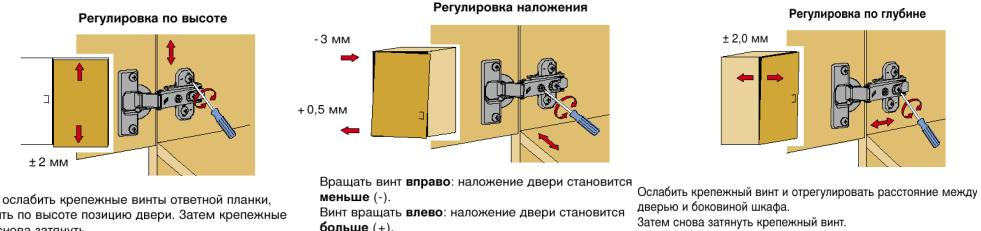
Рис.4 Схема установки эксцентрика
