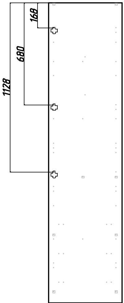
Рис.6 Схема установки крестовин петель
