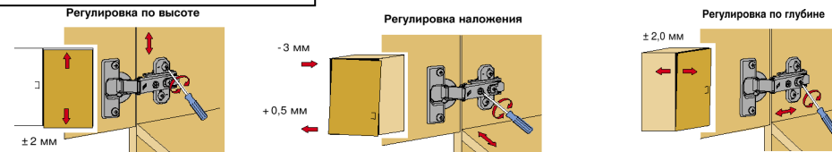
Рис.3 Схема установки петель
