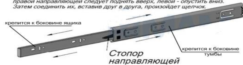
Рис.2 Схема установки шариковых направляющих
