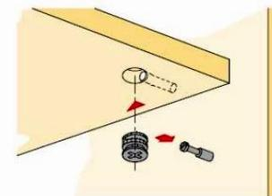
Рис.3 Схема установки эксцентрика
