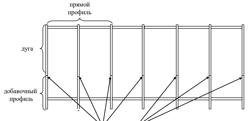
В местах крепления дуг с добавочным профилем, используйте болты 6×20 мм, в остальных случаях 6×25 мм
