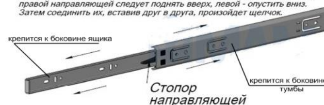
Рис.3 Схема установки шариковых направляющих
