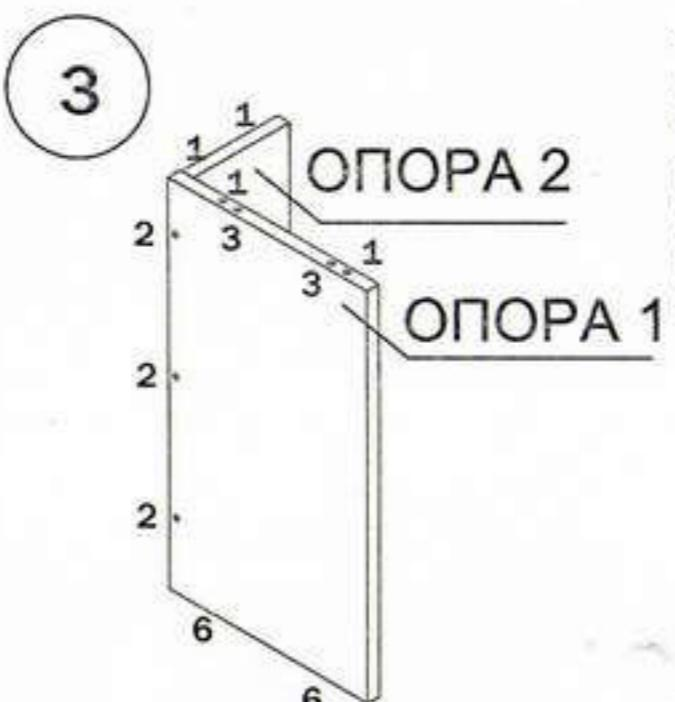
Закрутить в муфты столешницы Стол прям 100 дюбеля стяжек-растекс (4). Соединить столешницу с каркасом тумбы и опорой.
