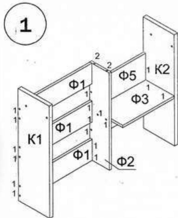
2. Забить шканты (2) в стойку среднюю  $\Phi 2$ . Соединить полку верхнюю  $\Phi 1$  с каркасом надстройки (детали K1, K2 и  $\Phi 2$ ). Фиксацию полки  $\Phi 1$  с боковинами K1 и K2 произвести при помощи евровинтов (1).
