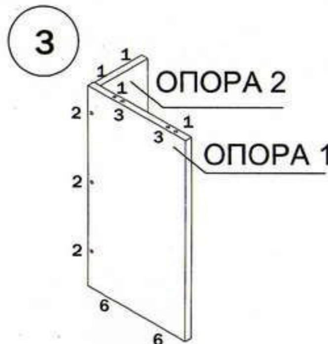
Закрутить в муфты столешницы Стол крыло 120 дюбеля стяжек-растекс (4). Соединить столешницу с каркасом тумбы и опорой.
