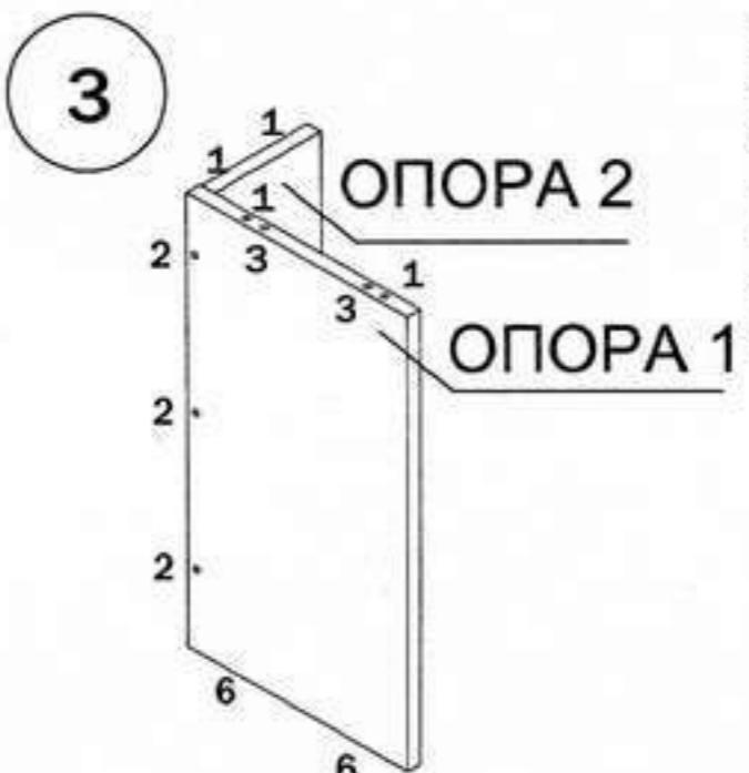
Закрутить в муфты столешницы Стол кпыло 120 дюбеля стяжек-растекс (4). Соединить столешницу с каркасом тумбы и опорой.
