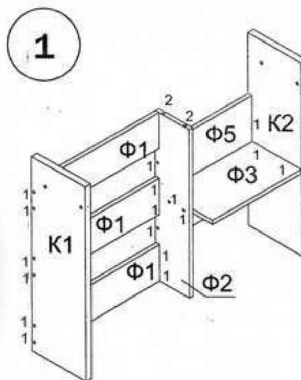
2. Забить шканты (2) в стойку среднюю Ф2. Соединить полку верхнюю Ф1 с каркасом надстройки (детали К1, К2 и Ф2). Фиксацию полки Ф1 с боковинами К1 и К2 произвести при помощи евровинтов (1).
