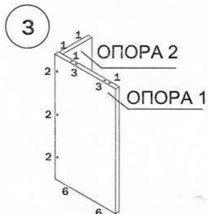
Закрутить в муфты столешницы Стол угол 120 дюбеля стяжек-растекс (4). Соединить столешницу с каркасом тумбы и опорой.
