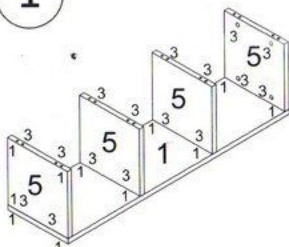
2. Соединить полки 6 и 2 со стойками 5 при помощи стяжек-растекс (3). Забить шканты (2) в полки 6 и 2 так, чтобы выступающая часть шканта составила примерно 20 мм.
