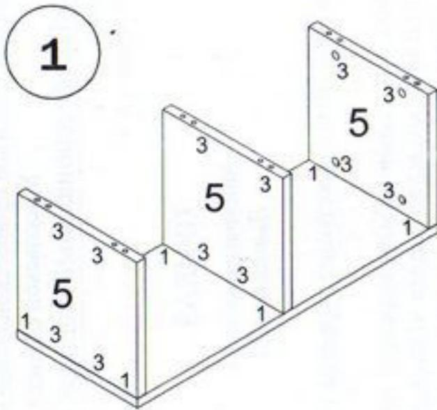
2. Закрутить в полку 8 дюбеля стяжки-растекс (4). Соединить полку 8 со стойками 5. Забить шканты (2) в полку 8 так, чтобы выступающая часть шканта составила примерно 20 мм.
