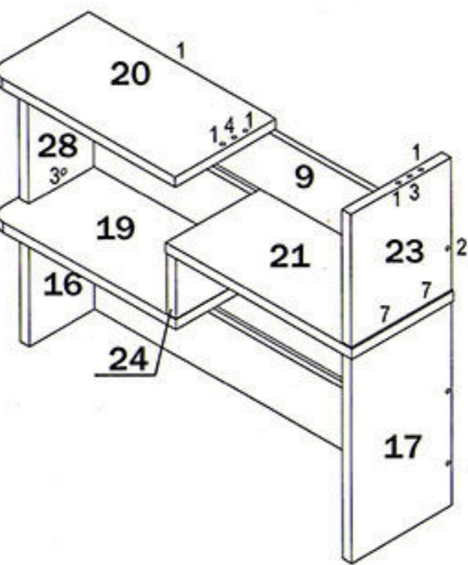
4. К полке 20 присоединить стойку 25 при помощи шкантов (1) и стяжек-растекс (3). Между деталями 23 и 25 вставить планку 18. Закрутить дюбеля стяжек-растекс (4) в муфты полки 22, и соединить ее с деталями 23 и 25. Поставить декоративные заглушки (8) и (10) в местах установки евровинтов (2) и стяжек-растекс 3)
