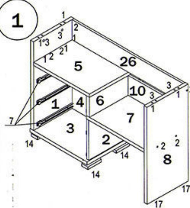
Забить шканты (1) в соответствующие отверстия планок 10 и 26. Соединить планку 10 с деталями 8 и 6. Установить планку 26 между деталями 8 и 1 и зафиксировать ее при помощи евровинтов (2), для чего необходимо слегка ослабить фиксацию винтов (2) на стойке 8, а после установки планки 26 снова зафиксировать их.
