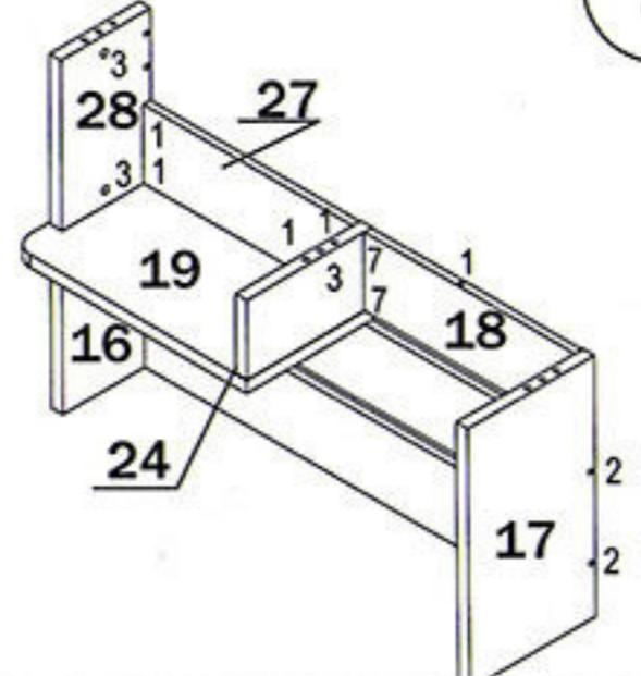
2. Соединить планку 18 с бокиной 17 с использованием шкантов (1). Закрепить стойку 24 с полкой 19., стяжкой-растекс (3). Соединить планку 27 со стойкой 24 (используются шканты (7) и с бокиной 28 при помощи шкантов (1)).
