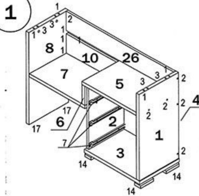
Забить шканты (1) в соответствующие отверстия планок 10 и 26. Соединить планку 10 с деталями 8 и 6. Установить планку 26 между деталями 8 и 1 и зафиксировать ее при помощи евровинтов (2), для чего необходимо слегка ослабить фиксацию винтов (2) на стойке 8, а после установки планки 26 снова зафиксировать их.
