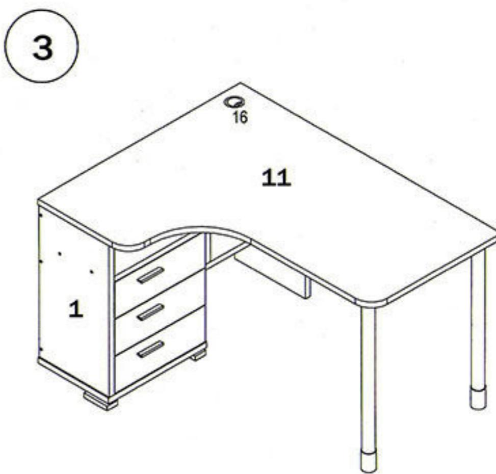
Соединить столешницу 11 с каркасом стола, при помощи шкантов (1) и стяжек-растекс (3). Собрать выдвижные ящики (см. сборка ящиков), и вставить их в каркас стола. Поставить декоративные заглушки (10) и (11) в местах установки евровинтов (2,6) и стяжек-растекс (3,19) соответственно
