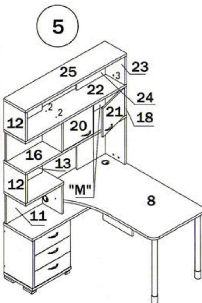
Вставить заглушки (16) в отверстия диаметром 60 мм расположенные на деталях 8 и 9..
