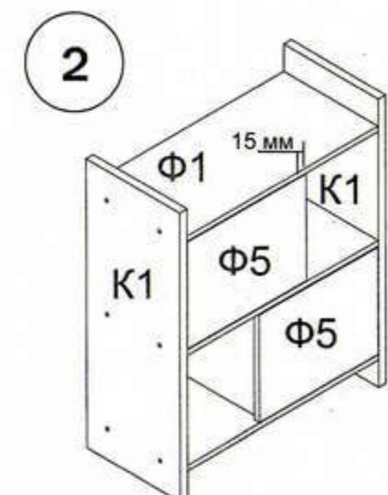
Для удобства открывания двери используется выступ двери относительно стойки 15 мм. При необходимости имеется возможность регулировки положения двери при помощи петель (3).
