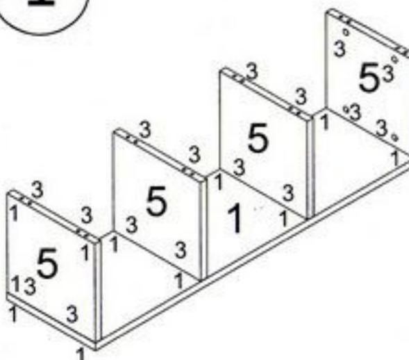
2. Соединить полку 2 со стойками 5 при помощи стяжек-растекс (3). Забить шканты (2) в полку 2 так, чтобы выступающая часть шанта составила примерно 20 мм.
