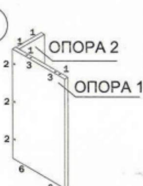
Закрутить в муфты столешницы Стол прям 100 дюбелей стяжек-растекс (4). Соединить столешницу с каркасом тумбы и опорой.
