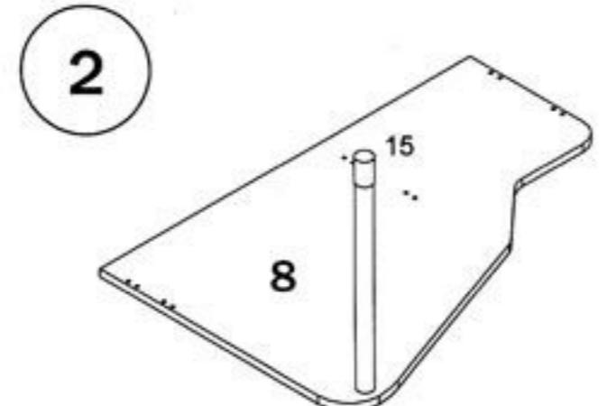
2. Прикрутить к столешнице 8 опору (15) при помощи саморезов (20).
